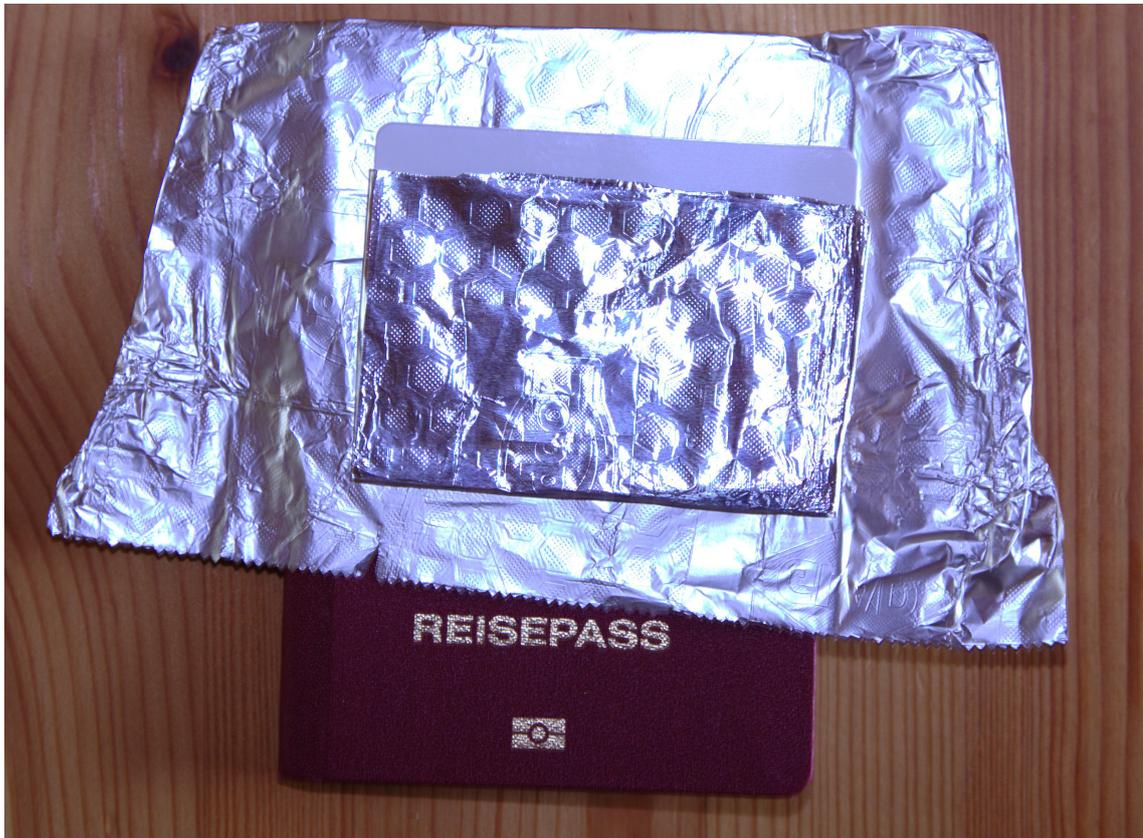
**Abbildung 5.5:** Ein in Alufolie gewickelter Reisepass und NFC Tag
